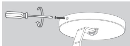
Conecte os cabos do produto à rede elétrica. Fixe o suporte ao forro com as buchas e parafusos que acompanham o produto e, em seguida, parafuse a canopla ao suporte.
