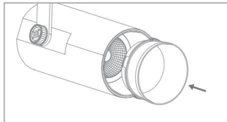
Posicione a lâmpada no interior do Spot e, em seguida, insira o flange frontal. Pressione até ouvir o clique.
