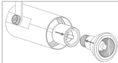
Passa o soquete por dentro do corpo do Spot e encaixa a lâmpada pela frente.
